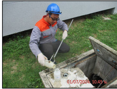
บ่อกักน้ำทิ้งหลังออกจากระบบบำบัดน้ำเสียรวม
